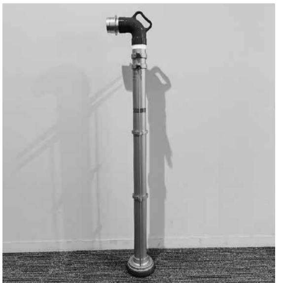
スタンドパイプ: 消火栓に差し込み、ホース・筒先を結合することで、毎分100リットル以上の放水ができる消火用機材
