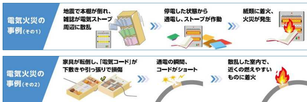
図 5-9 電気火災の発生プロセス (出典) 出火防止対策・初期消火対策パンフレット(東京都)
