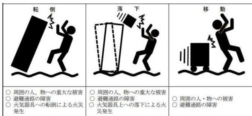
図 5-4 地震による家具類の動きと被害 (出典) 家具類の転倒・落下・移動防止対策ハンドブック (東京消防庁)
