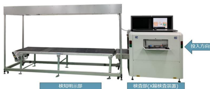
リチウムイオン電池等検知システム外観
