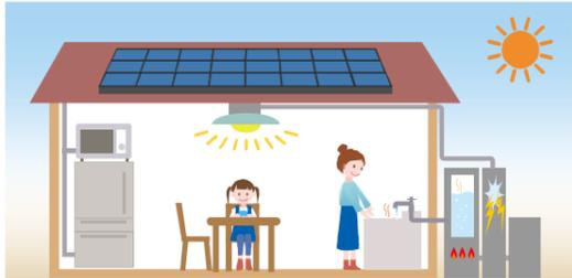
住宅や事業所の屋根に太陽光発電機器を導入し、発電した電気を利用しています。また、燃料電池を普及させることで、省エネ化や停電時のエネルギー利用が可能となっています。
