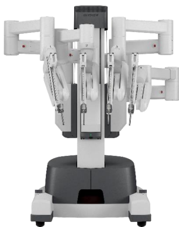
②ペイシェントカート
